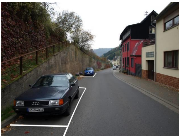
Abbildung 64: gezielte Ausweisung von Stellplätzen im Straßenraum durch Markierung
